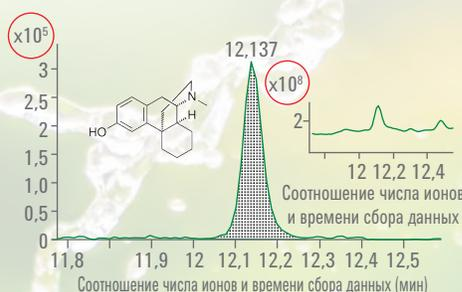
Алгоритм разработки формул Agilent позволяет обнаружить декстрорфан в присутствии совместно элюирующих ионов в пропорции 1:1000.
