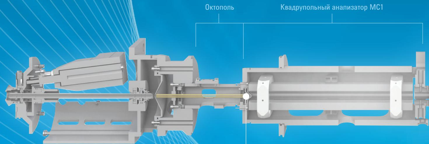
Линзы перед входом в квадруполь — большой диаметр обеспечивает повышенную надежность
